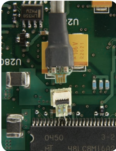
InfiniiMax ZIF tip soldered on board
